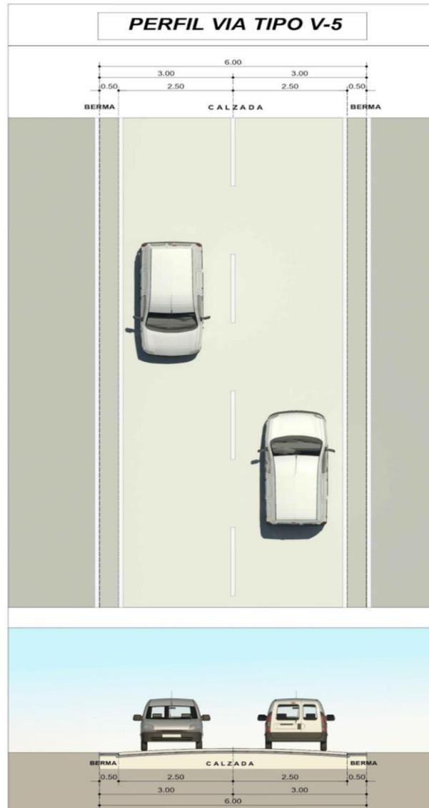
Ilustración 30. Perfil Vial V-5.
